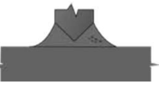
31 Porosity in Fillet (sub-surface) UT, RT
