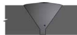
39 Porosity in Fillet (sub-surface) UT, RT
